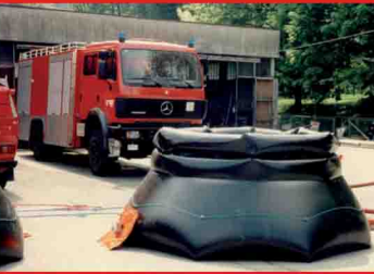
▪ Réservoir de récupération d'effluents chimiques
